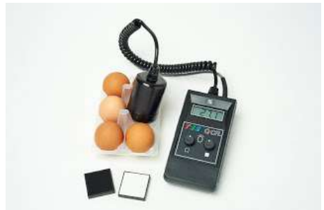
Shell Colour Reflectometer , sebuah alat untuk mengukur warna kerabang telur
