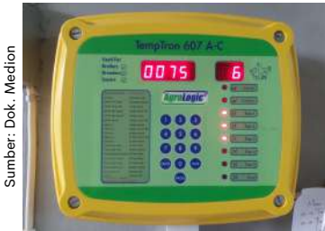
Temptron 607 A-C, dilengkapi sensor suhu dan kelembapan
